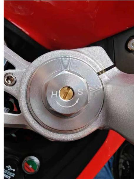
Pour régler la vitesse de détente, réglez les suspensions sur Heavy ou sur Speed.
